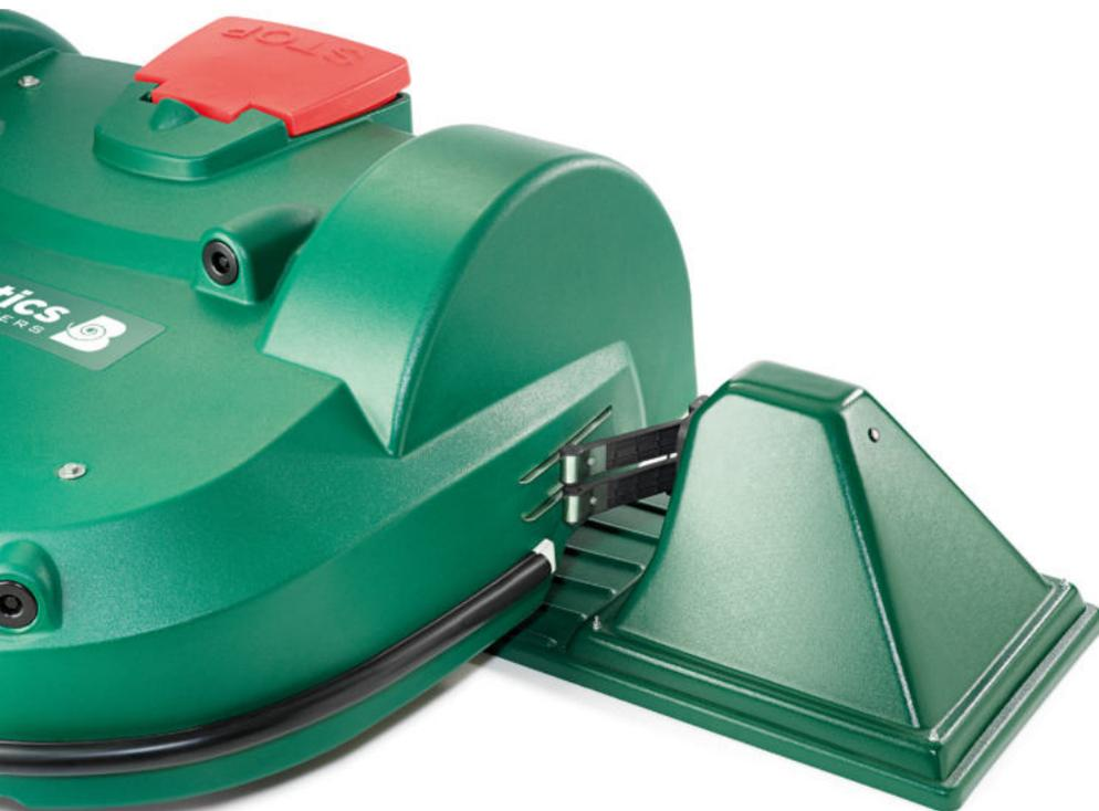
„Mehrere Felder“: Die Belrobotics-Roboter können so programmiert werden, dass sie mehrere durch verschiedene Begrenzungsdrähte abgegrenzte Bereiche mähen.
